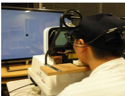
4K 画像観察中の眼球運動と調節の測定 Measurement of Eye Movement and Accommodation
