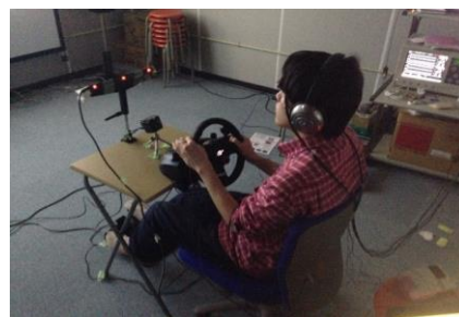
4K ドライブシミュレーターで運転中の眼球運動測定 Eye Movement when driving 4K Drive Simulator
