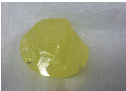
図3 硫黄の単結晶（単方晶）の状態のもの（筆者撮影）
