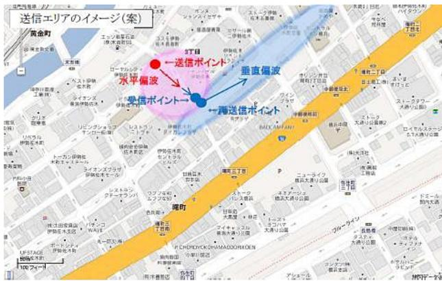
図3 電波中継によるエリア拡張図
