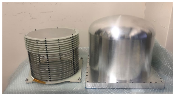
図 1 3 号機 ETCC の耐圧容器 (右) および電子ドリフトゲージ (左)。
