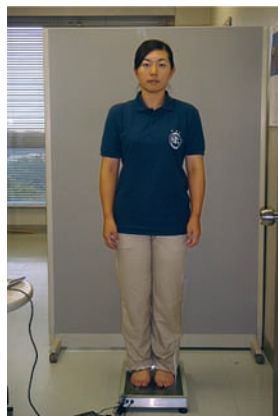
図1 フットルック：足底用スキャナーと専用ソフト入りパソコン Fig. 1 FootLook: The Scanner for Taking Footprints and PC for Analyzing Data
