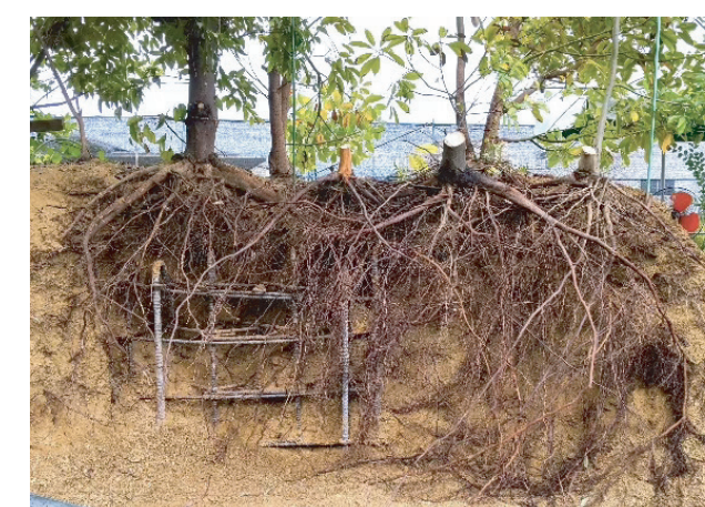
図2 6年間生育した試験盛土内の根系と鉄筋の様子 Figure 2: Root systems and rebar in a test embankment after six years of growth
