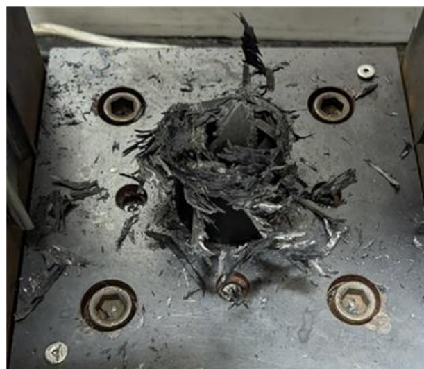
(b) Specimen E [45^\circ/-45^\circ/45^\circ/-45^\circ/45^\circ]
