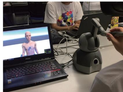
聴診技術習得のための生体シミュレータ。患者に触れた感触が得られ、聴診器先端が患者に当たる角度の違いに応じた聴診音が再生される。
