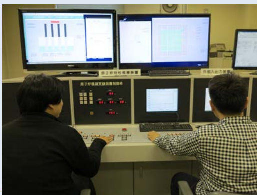
図 原子炉シミュレータ (左図：研究炉用、右図：発電炉用)。
