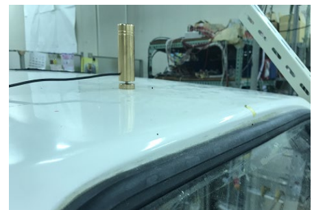
車両の天井に設置したアクチュエータ Actuator installed on the roof of a vehicle to generate sound wave
