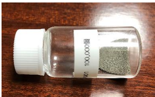
写真7 セラミックコンデンサ 親指大の小瓶に10万個が入っている
