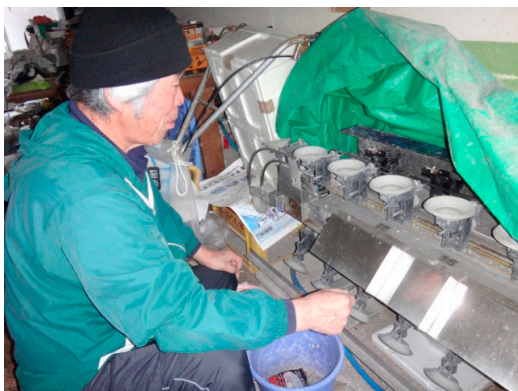
写真20 津島町、母貝屋河野氏の作業小屋に置かれた母貝選別機。皿に母貝を乗せベルトコンベヤー式に運び、重量別に指定か所で落下させ選別する。松山市の横崎製作所は1977年に養殖真珠用母貝の重量選別機の製造を開始し、1986年から魚重量選別機を製造、1991年からはサクランボ、トマトなど農産物選別機を製造している。重量や選別数は、目的に応じて設定でき、重量精度は2%以下。2018年2月10日、筆者撮影。
