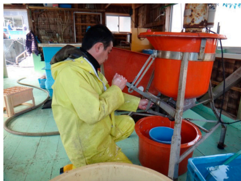
写真56 津島町、佐々木氏の筏小屋、分離器で真珠貝の内蔵から分離し、沈殿した真珠を取り出す作業。2018年2月9日、筆者撮影。
