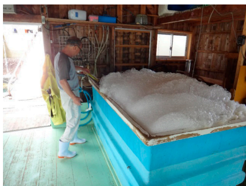
写真26 津島町、佐々木氏の筏小屋に設置されたオゾン処理の水槽。挿核前の母貝の「卵抜き」のために、卵抜きカゴから出した貝をオゾン発生装置の付いたオゾン水槽に入れる。オゾンによって貝に付いた雑菌やウイルスが消毒されるとともに、卵が放出されるという。放卵によって泡立った卵は水槽からオーバーフローし排出する。オゾンによる放卵の仕組みは、佐々木氏にも正確な説明は不詳で、経験的な試行錯誤の一つ。水槽底面に水温を摂氏22から25度に調整する熱管がある。このオゾン殺菌装置は2000年頃に導入。2017年7月10日、津島町にて筆者撮影。
