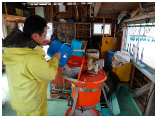
写真55 津島町、佐々木氏の筏小屋、真珠貝の内蔵を集めて分離器にかけて真珠を分離し沈殿させる作業。2018年2月9日、筆者撮影。
